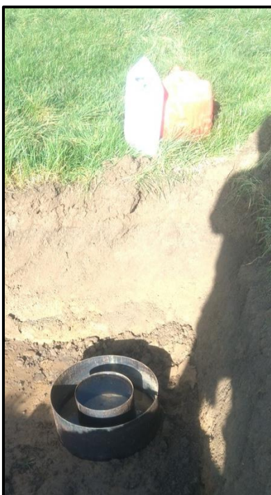
Photo 1 : Premier infiltromètre installé sur la zone étudiée (Agrosol, 2022)
