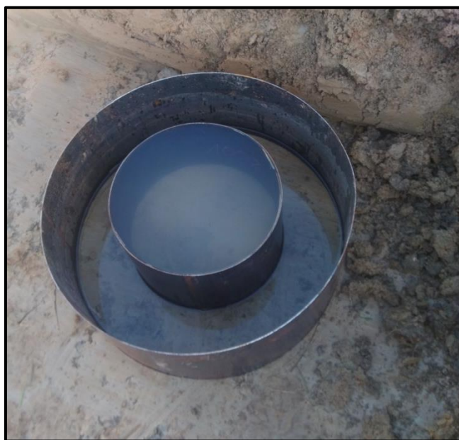
Photo 2 : Deuxième infiltromètre installé sur la zone étudiée (Agrosol, 2022)
